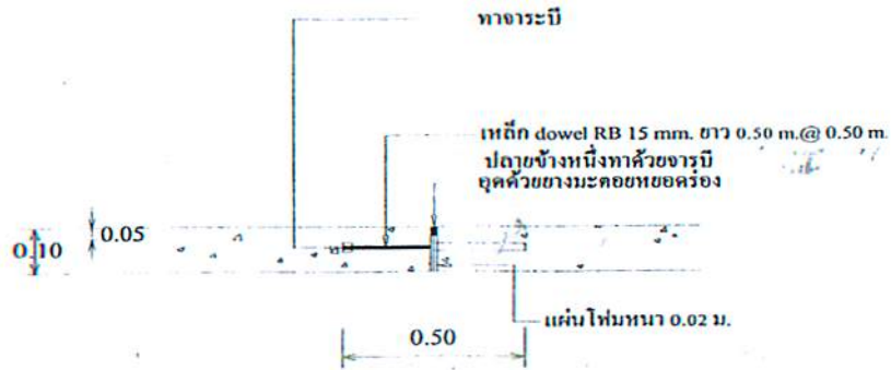
แบบขยาย(1) EXPANSION JOINT Scale 1:25
