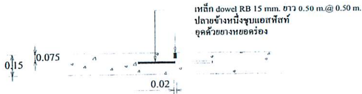
แบบขยาย(3) CONSTRUCTION JOINT Scale 1:25
